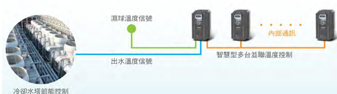
圖 8.4 冷卻水塔風扇變頻節能控制
