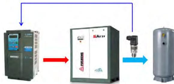
圖 5.4 空壓機變頻控制架構
