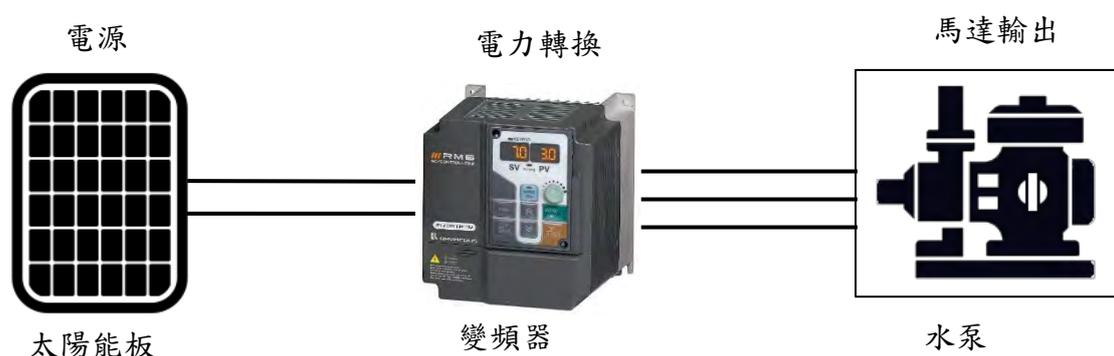
圖 7.1 Solar pump 基本架構
